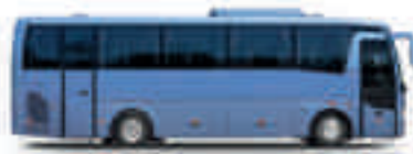
MD 9 Länge: 9,340 m, Höhe: 3,330 m (mit Klimaanlage)
