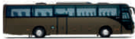
SAFARI RD 12 Länge: 12,200 m, Höhe: 3,420 m (mit Klimaanlage)
